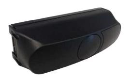
IR LEDを光源に利用した3D TOFセンサ。160×60の9,600画素の距離情報が 測定可能です。従来は5mまでの検出距離でしたが、デュアルビーム化により 15mまで測定可能。外乱光特性は10万lux。
